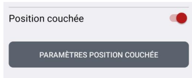
Fig. 41 : Activation de la détection d'homme mort avec position statique
