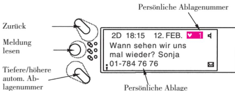
Alle Meldungen werden auf dem Display, eine nach der anderen, automatisch durchgeblättert. Dies kann folgendermassen unterbrochen werden:
