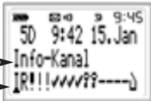
Je nach Programmierung kann der DE920/DE940 maximal zwei Meldungsordner aufweisen. In der Meldungsübersicht wird bei Auswahl der Titel des Meldungsordners angezeigt. Um die Meldungen im Meldungsordner anzuzeigen, die Bestätigungstaste drücken. Mit Hilfe der Scrolltaste können anschliessend die Meldungen gelesen werden.
