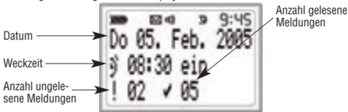
Falls die Scrolltaste gedrückt wird, wird die Batterieanzeige angezeigt, ansonsten wechselt der Swissphone DE920/DE940 nach der Rückfallzeit in den Bereitschaftsmodus.
